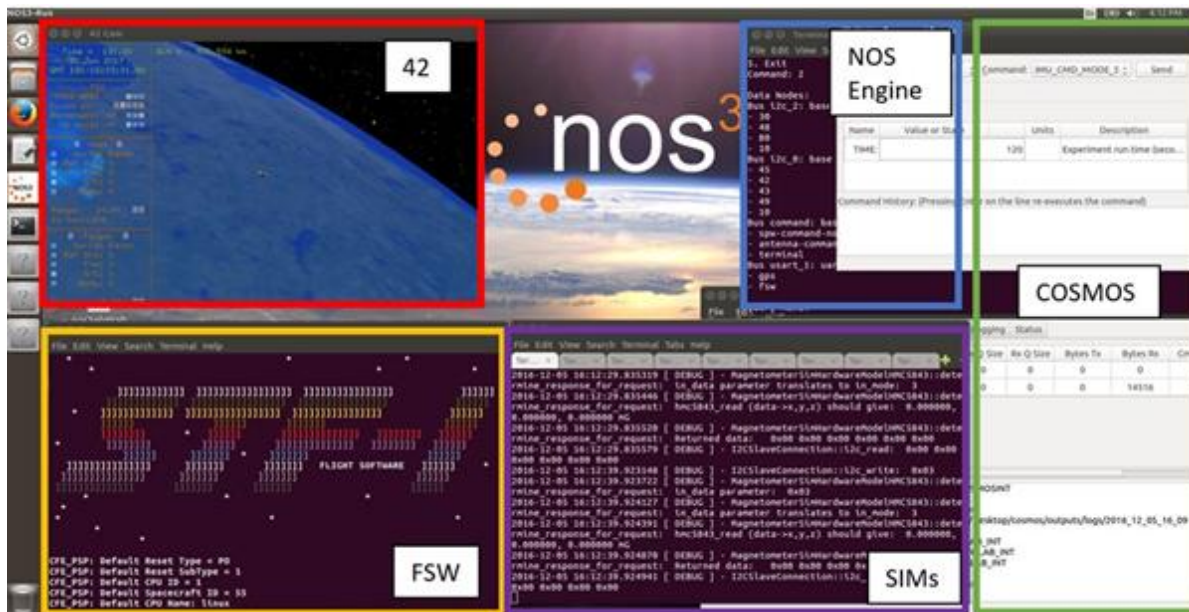
Obr. 45 Ukázka uživatelského prostředí simulátoru NOS3 v prostředí operačního systému Linux
