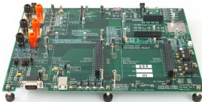
Obr. 41 Vývojová deska payloadu (experimentu) stavěbnice CubeSat IU
