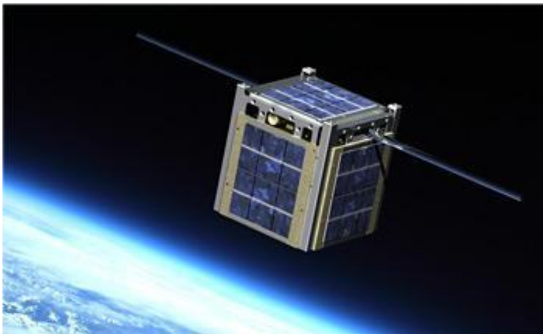
Obr. 4 . Základní modul Cubesat 1U (AMES Research NASA)
