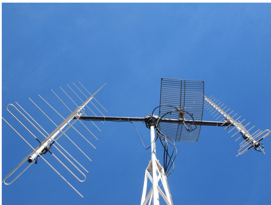
Obr. 28 Ukázka anténního systému pozemní stanice (vlevo zkřížená anténa YAGI pro pásmo VHF a vpravo pak pro pásmo UHF, uprostřed parabolická anténa pro S pásmo 1,23 GHz, elevační rotátor je uprostřed a celá soustava je na tyči upevněna do azimutálního rotátoru )
