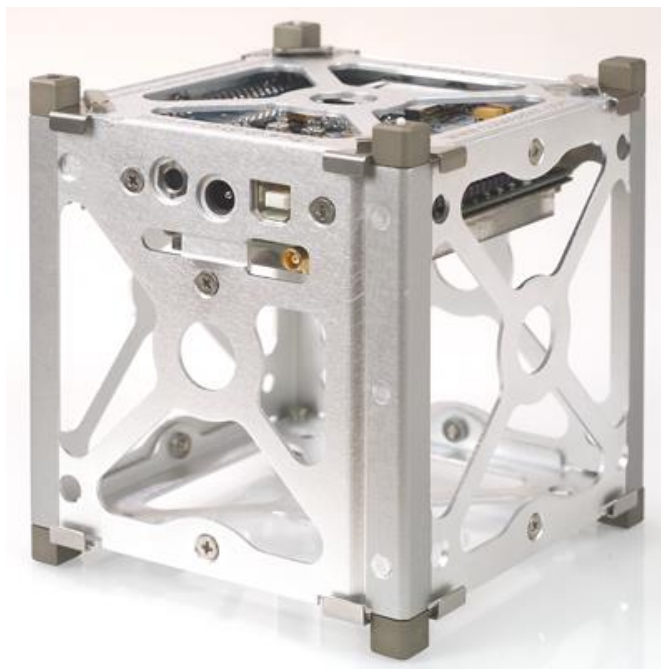
Obr. 37 Pikodružice modulu 1U a možnosti jejího stavebnicového rozšíření
